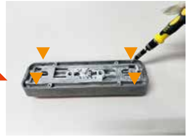
4カ所の「なべネジ」を外します。
