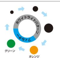
照度は~60,000lxまで調光スイッチで無段階に調整が可能。ホワイトライトは3段階の照明範囲セレクターを搭載し、マイクロスコープの眼への負担を軽減します。カラーフィルターは照明によるレジン硬化反応を抑制するオレンジフィルターと、血流組織等の視認性を向上するグリーンフィルターの2種のフィルターを搭載しています。
