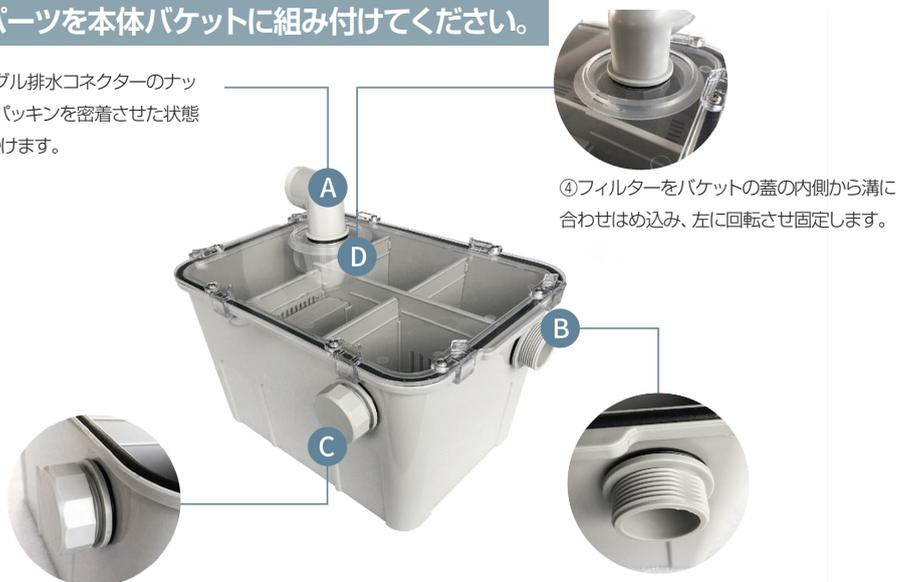
ゴムパッキンが外側になるようにバケットの外側から②排水コネクター (ナット付) を差し込み、内側からナットで固定します。
