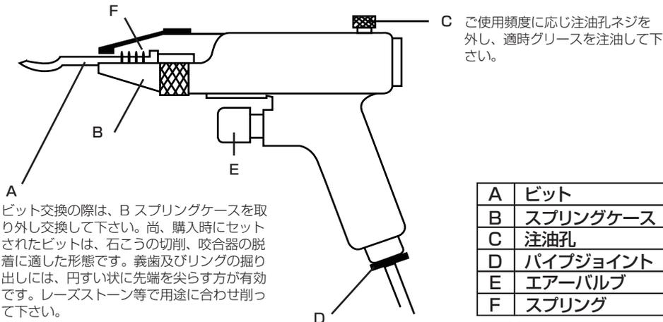
ビット交換の際は、B スプリングケースを取り外し交換して下さい。尚、購入時にセットされたビットは、石こうの切削、咬合器の脱着に適した形態です。義歯及びリングの掘り出しには、円すい状に先端を尖らす方が有効です。レースストーン等で用途に合わせ削って下さい。
