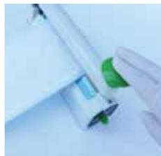
滅菌パックをシーリングする場合、ビニール面を下にしてシール作業を行ってください。紙面を下にしてシーリングすると紙を通してヒーターの熱が伝わるため、通常より発熱量が多く必要となり、タイマー目盛を3以上に上げなくては、ビニールが溶けなくなります。結果として焦げはじめが早くなり、消耗品の寿命も短くなります。
