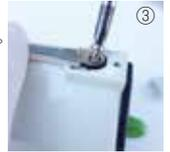
③ターミナルカバーを外すとヒーター線を固定するネジがあるのでネジを外し、新しいヒーター線と交換します。※機種によりヒーター線は全て異なります。必ず取付されていたものと同じ長さ、同じ巾のヒーター線であることをご確認ください。
