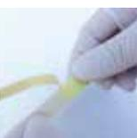
①上の方法でテフロンシート、ヒーター線を外した後、テフロンテープの裏面シールをはがします。(古いテープの糊が本体フレームに残っている場合はアルコールなどで拭き取り凹凸がないことを確認してください。)
