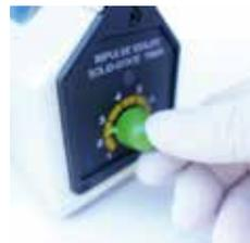
タイマーの通電時間は、きれいにシールできる最短時間でセットします。滅菌パックの場合、**加熱タイマーのメモリは2.5**を目安に。**連続使用の場合は2.5以下**で十分シール可能です。タイマーメモリ(加熱時)を必要以上にあげるとはシール不良(ビニールがトロケル、煙がでる、紙がコゲルなど)の原因となり消耗品の寿命も非常に短くなります。
