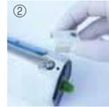
①左の手順でテフロンシートを外します。テフロンシートを外すとヒーター線が出てきます。ヒーター線が切れていれば交換してください。②手前にあるターミナルカバーを外します。
