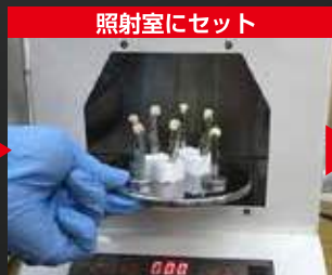
照射室内にターンテーブルを置くだけでセットできます。
