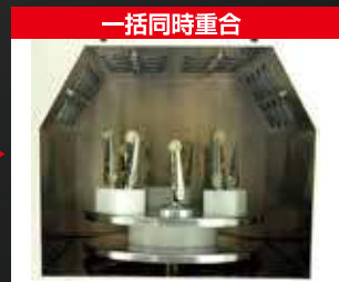
照射室内にターンテーブルをセット 仮重合 15秒 最終重合 120秒
