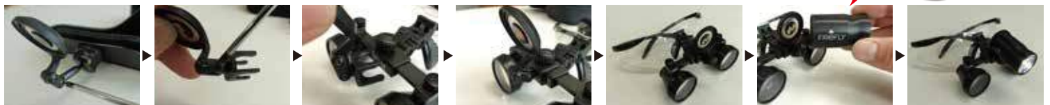
ヘッドバンドに付いているマグネットマウントを取り外します。 お手持ちのルーペに適合したスライドヒンジをマグネットマウントに固定します。 スライドヒンジをルーペに差し込みます。 ルーペに固定します。 ライトポットを着ける前の状態。 マグネットマウントにポットを取り付します。 ポットを回転させれば、ON/OFF・LIGHT/LOWの切替が可能です。
